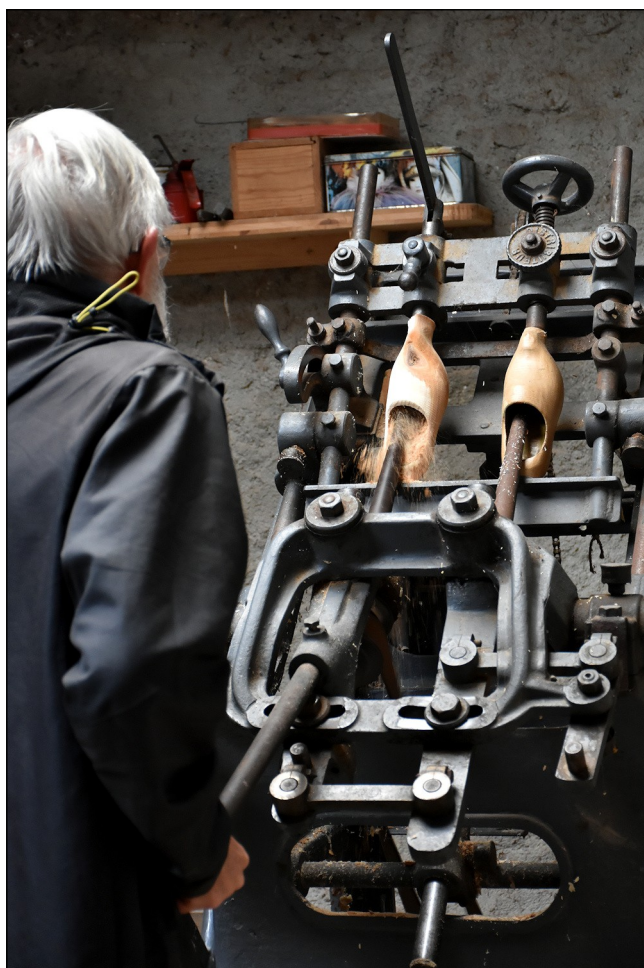
André pilote la creuseuse pour fabriquer un sabot Photo : Henri Couroussé ©
